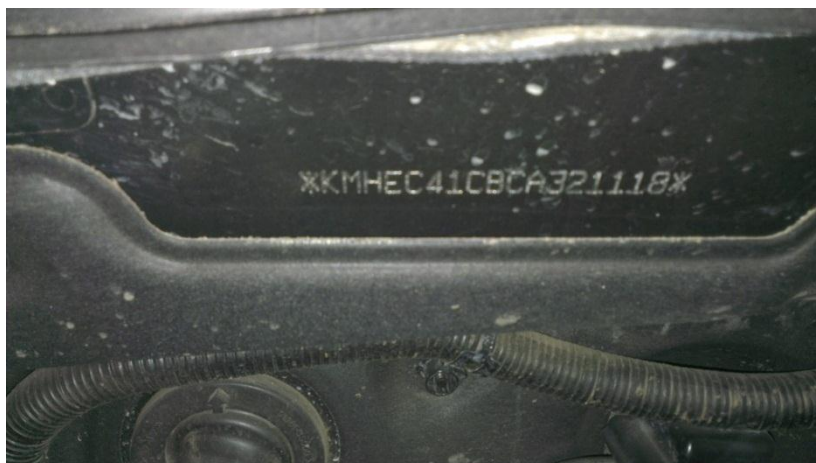
هیوندای سوناتا YF محل حک شماره شاسی : روی سینی موتور
